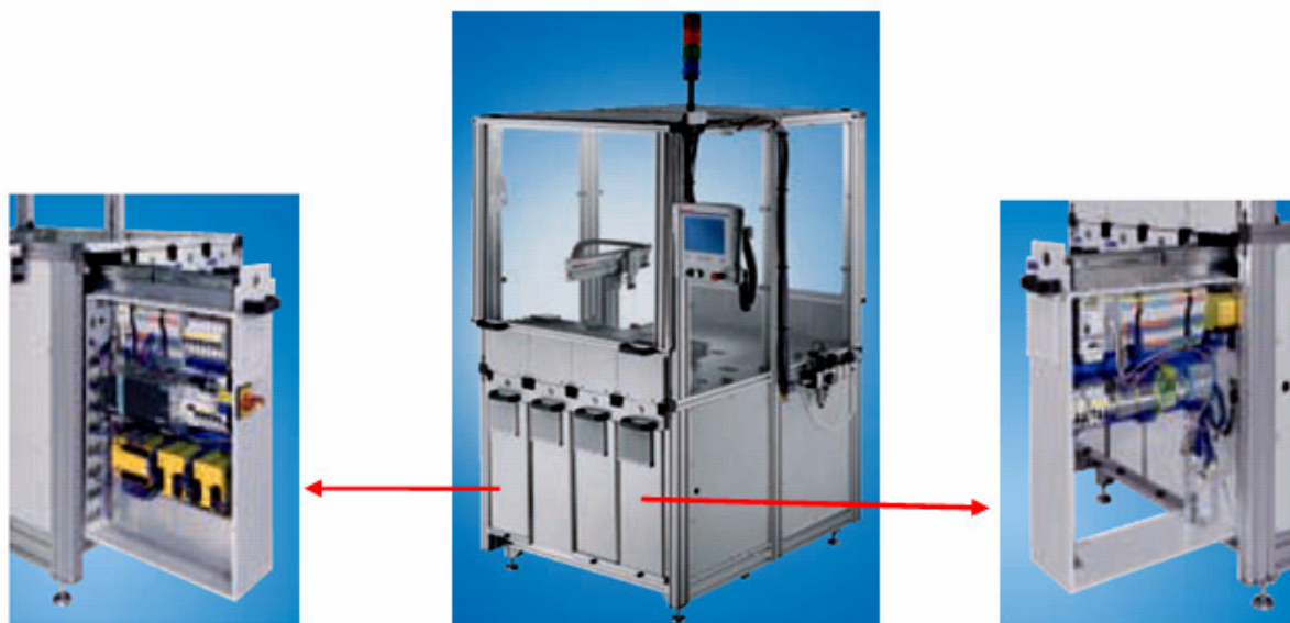
Obr. 2: Základný rám nosnej konštrukcie pracovnej stanice so zásuvnými funkčnými modulmi [4]
