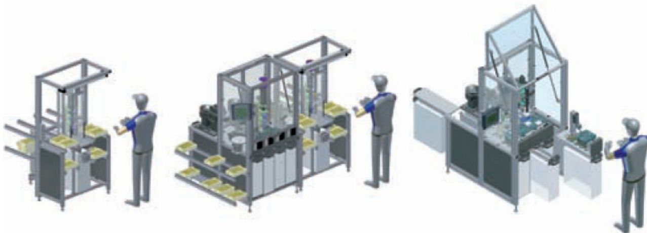
Obr. 1: Modelovanie stavebnicovej štruktúry ručnej pracovnej stanice, polo automatizovanej a automatickej linky [5]
